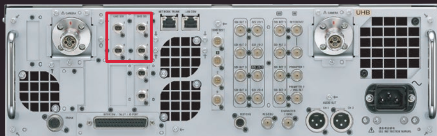
HDCU-5000 后视图 (安装了选购的 HKCU-UHF50)
