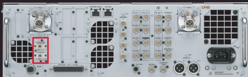
HDCU-5000后视图 (安装了选购的 HKCU-SM50)
