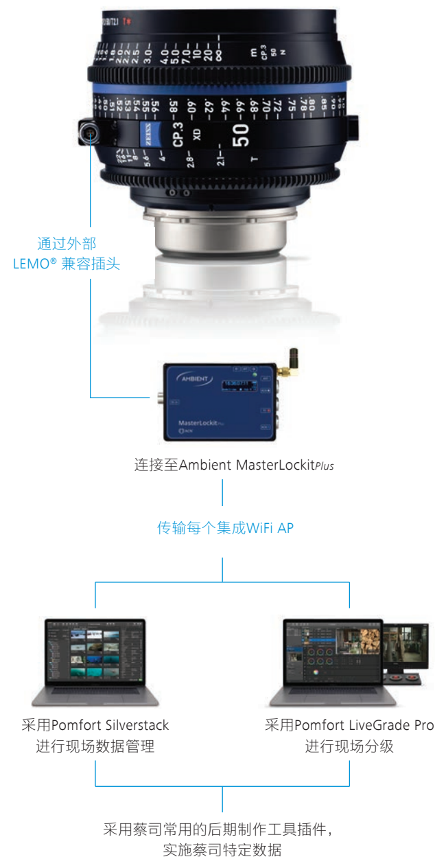
通过外部的LEMO® 兼容插头，记录ZEISS eXtended Data
